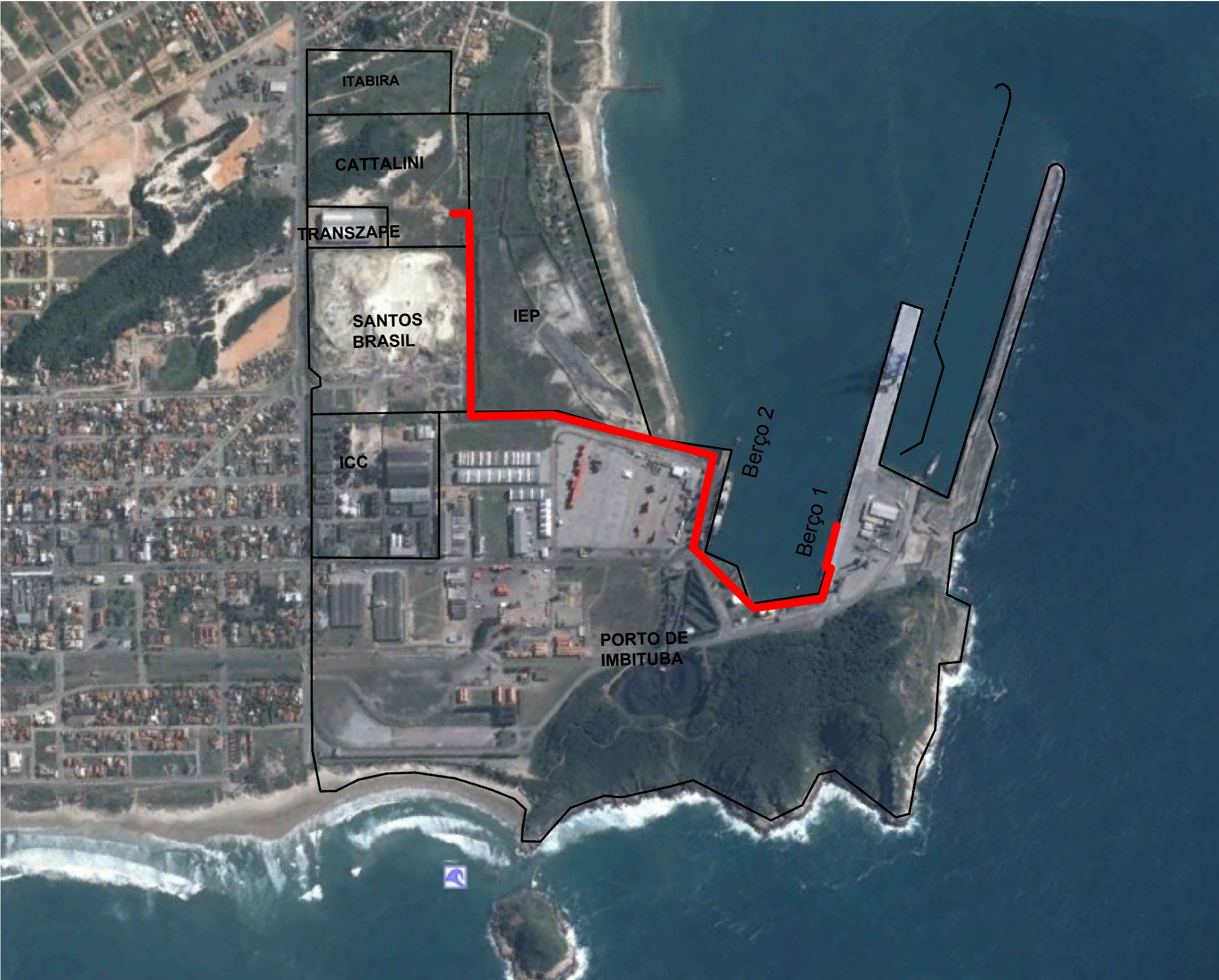
Trajeto 3 – Saída Opção B Comprimento médio 2.000m 5 Dutos Ø 12" - Aço Inox 304-L - 150Lbs - Sch 10s
